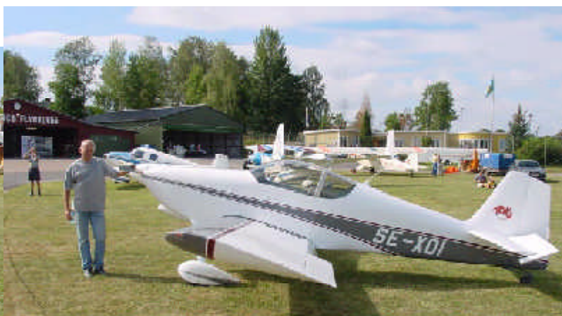
Ernst Totland visade upp sin egenhändigt byggda Vans RV6. Med 4-cylindrig Lycomingmotor så marschar det lätt 150 knop.
