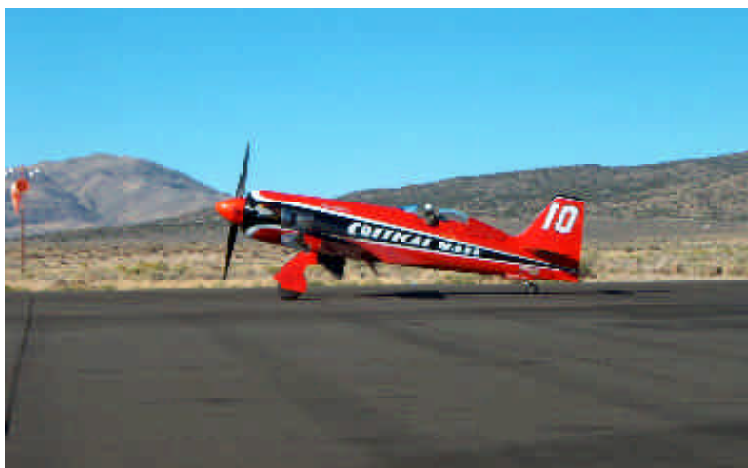
Sea-Fury Critical Mass med modifierad motor till 4.000 hk.
