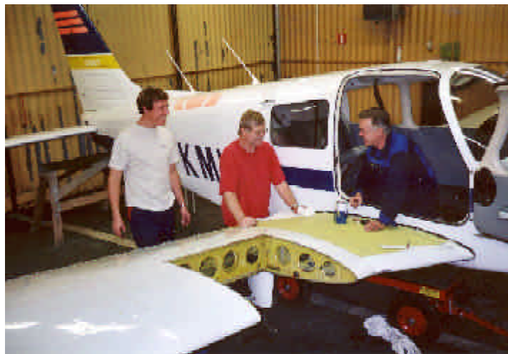
Det stora urtaget på vingens framkant är platsen för bränsletanken.
