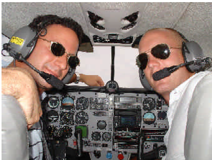
Höjdhållande autopilot, HSI, GNS430, avisning på vingar och propeller, stormscope och dubbla horisontgryon (varav ett elektriskt) är exempel på utrustning som finns i SE-LBM och som kommer väl till användning vid reseflygning.
