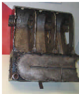
Motorblocket till motorn som användes vid de första flygningarna. Gick sönder när en vindpust vältte planet.
