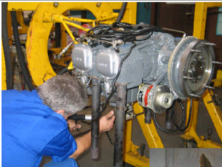
En nysammansatt motor sätts upp i ett fundament...
