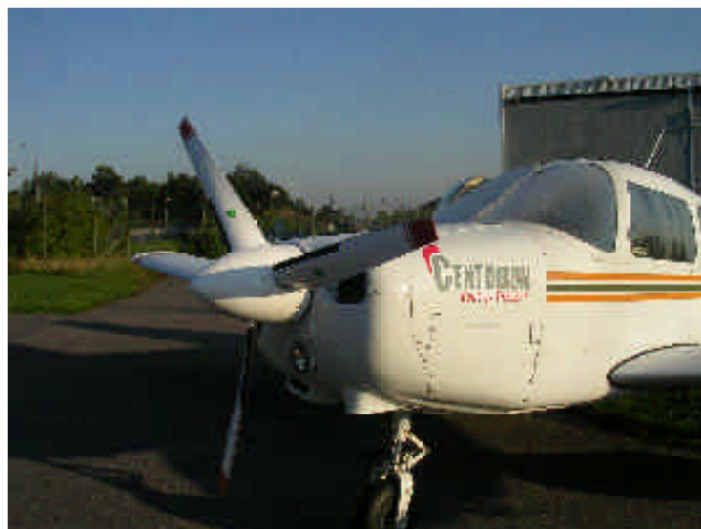
PA28 Warrior med Thielertmotor har 3-bladig propeller som bidrar till den låga ljudnivån
