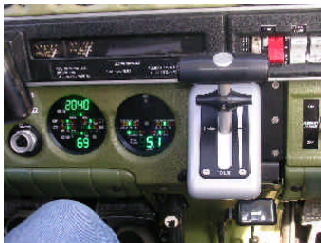
Interiör med motorinstrument för Thielert-motorn. Med gasreglaget ställer man in önskat effektuttag i procent, FADEC-datorn sköter inställning av varvtal mm. Datorn gör också run-up före flygning. Enkelt handhavande alltså, men ett antal temperaturer och tryck ska övervakas under flygningen.
