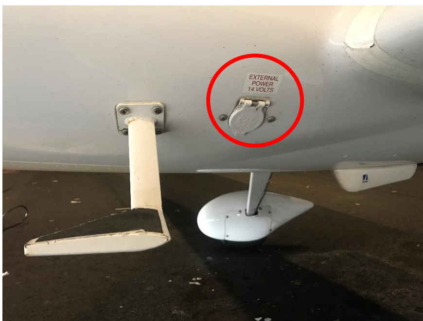
Fig. 1 - PA- 28. Uttag för yttre kraft och motorvärmare
