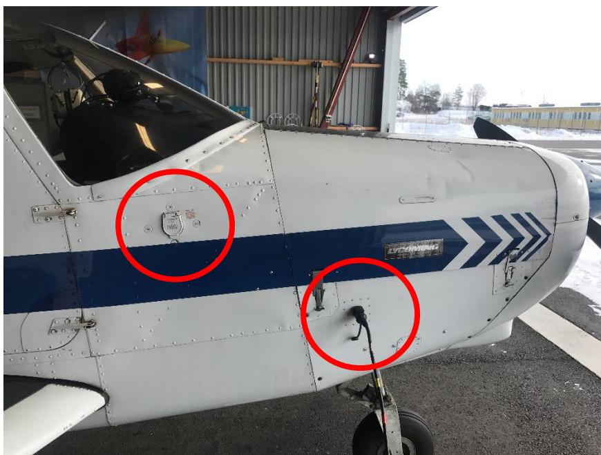
Fig. 1 - PA- 28. Uttag för yttre kraft och motorvärmare
