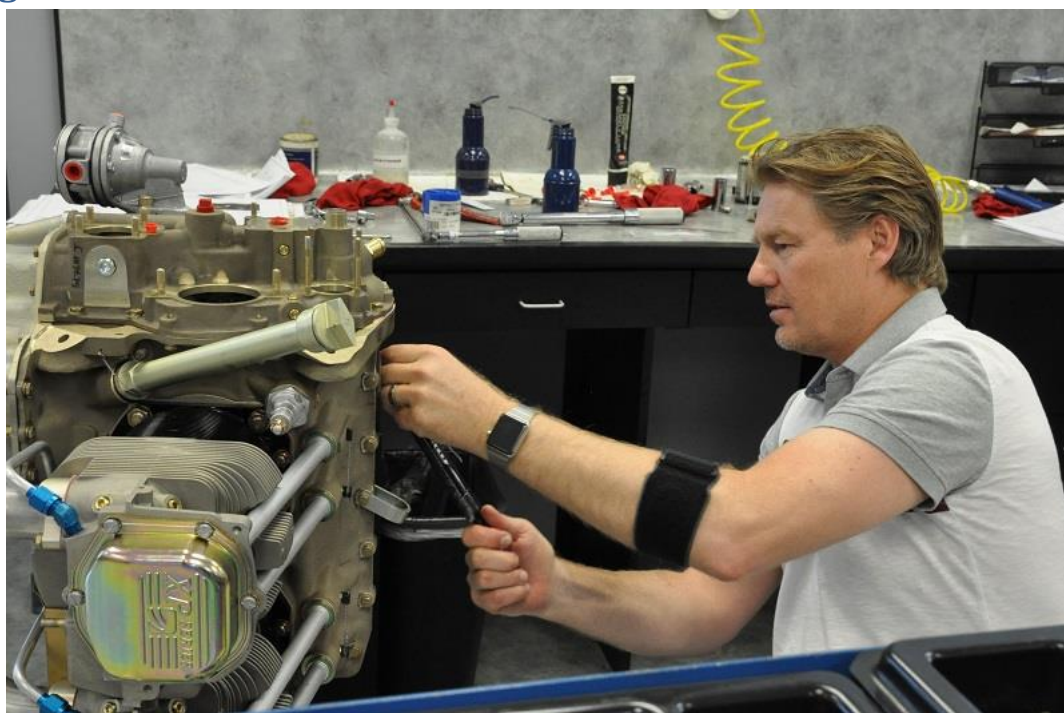
Cylindrar och hjälppapparatslocket baktill är monterade, och här låser Magnus stoppskruvarna för ventillyftarna
