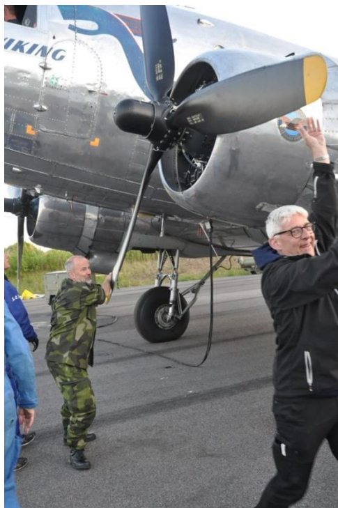
Ventilation av en Pratt & Whitney Twin Wasp! Foto: Anders Wallerman
